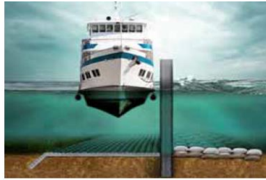
Protección de lecho
