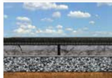
Sanierung von Betonflächen mit Asphalt
