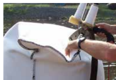
Cierre de las bolsas mediante una máquina de coser manual
