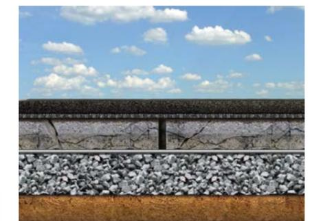
Rehabilitación de firmes rígidos de hormigón con aglomerado asfáltico
