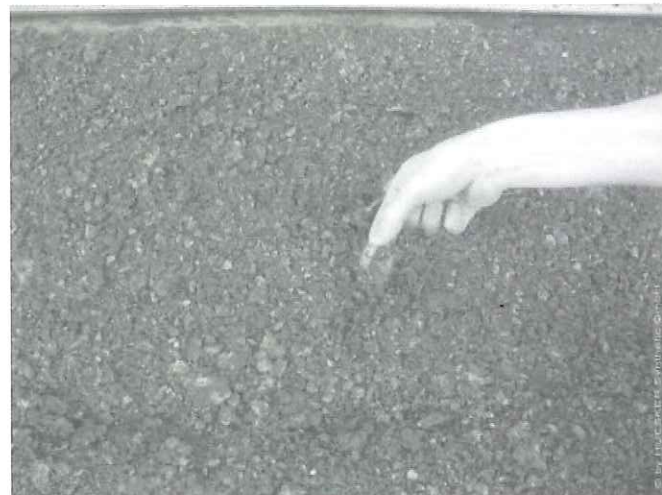
Fig. 23 - Piccoli frammenti di geogriglia in un conglomerato scarificato
