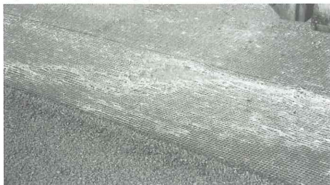
Fig. 9 - Geogriglia sensibile al danneggiamento
