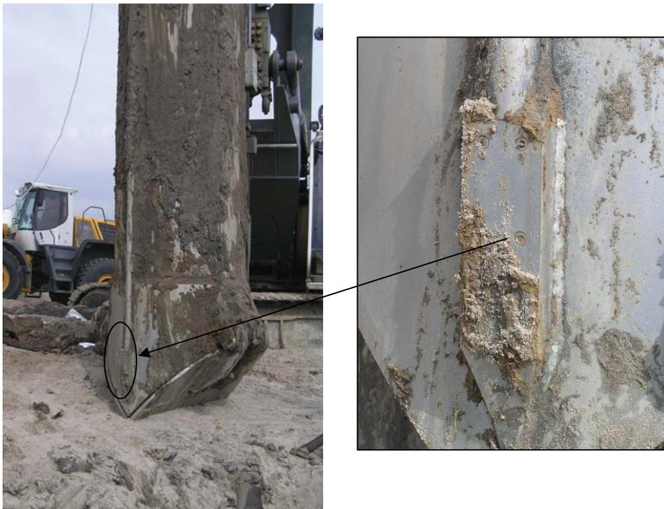
Abb. 7: Ausrüstung eines Verdrängerohres mit Messtechnik für Erfassung akustischer Signale
